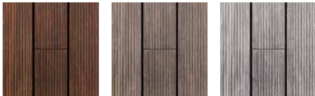
Evolución del color de Bamboo X-treme en el tiempo: después de la instalación (izquierda), después de 3 meses (centro) y tras 18 meses (derecha).
